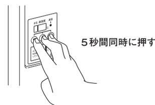
**2** 設定モードに切り替わると、湯温度表示が「T-1」の点滅表示になります。
